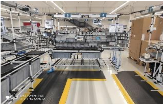
Línea en U con puestos nivelados
